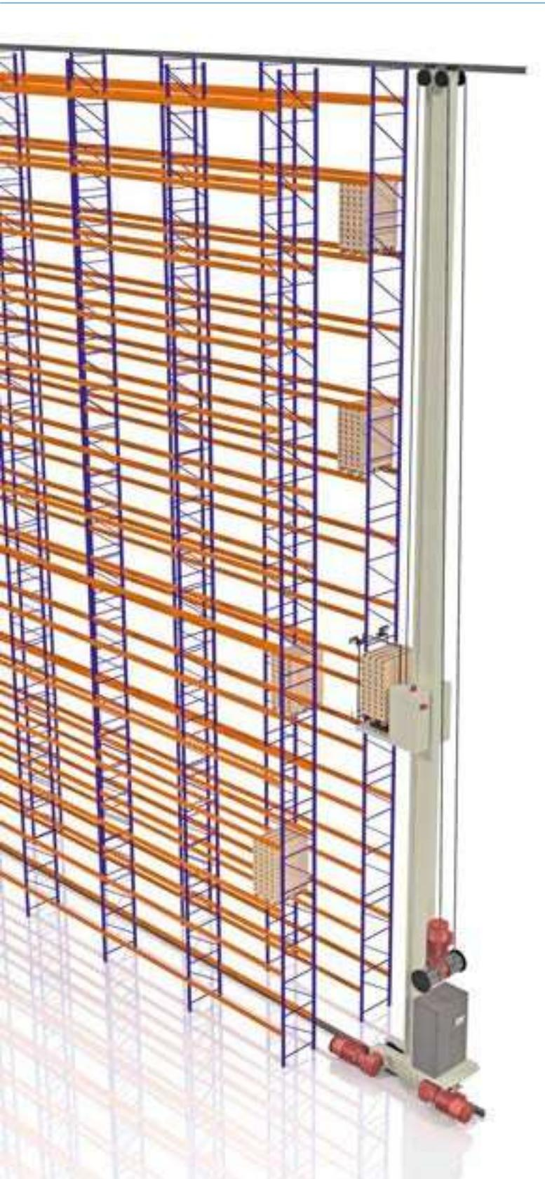
Abbildung 18: Regalbediengerät mit erneuerter Steuerung, Sensorik und Aktorik
