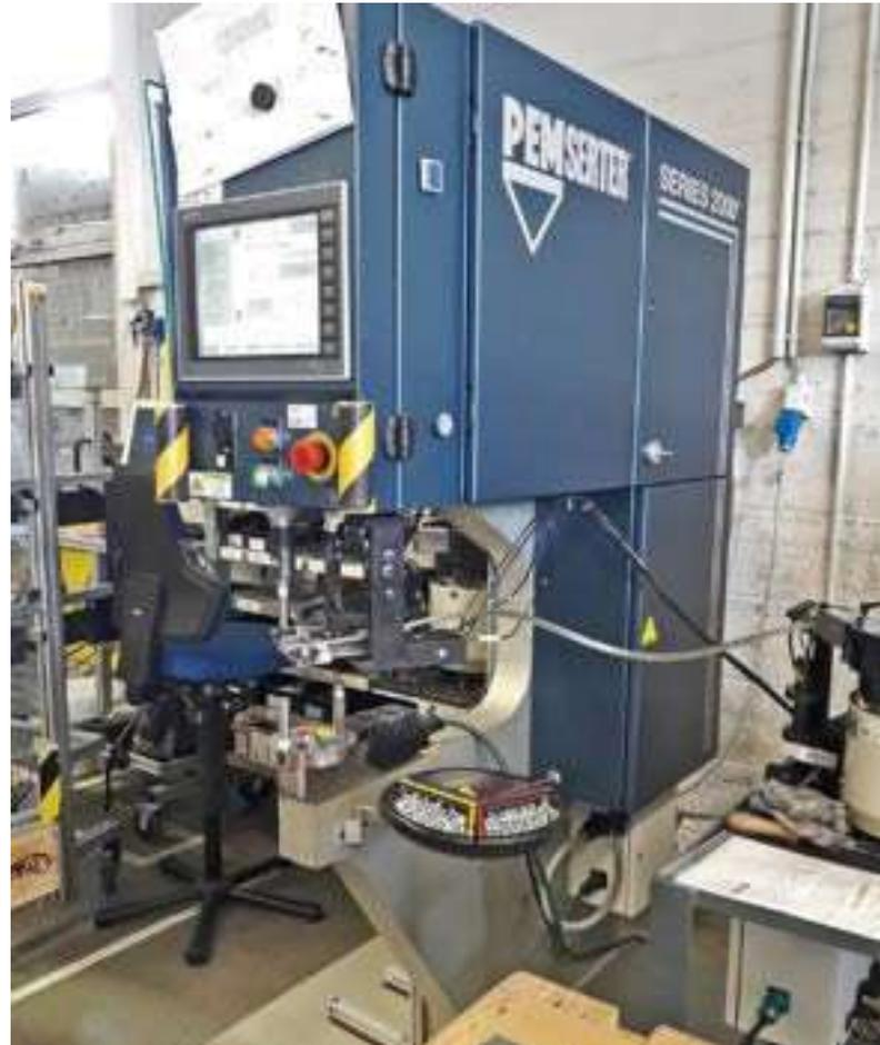
Abbildung 6: Einpressautomat
