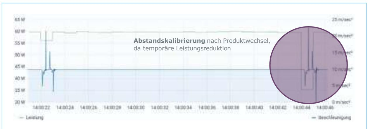
Abbildung 10: Abstandskalibrierung nach Produktwechsel
